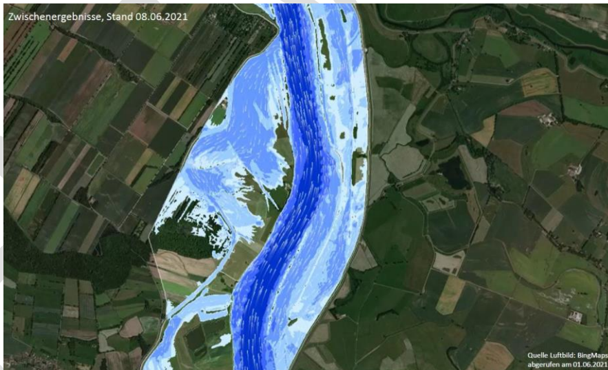
Flutung der Deichrückverlegung Vitico im hydraulischen Modell (Quelle: Institut für Wasserwirtschaft und Umweltschutz)
