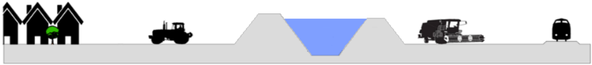
Prinzipische Skizze: altes Hochwasserschutzsystem
